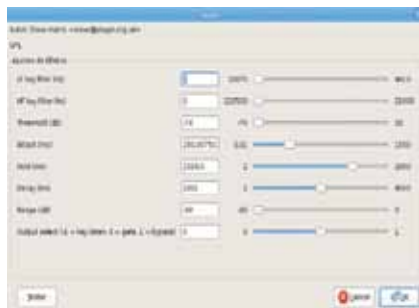
Figura 40 – Um processador gate que compõem o conjunto de plugins LADSPA
