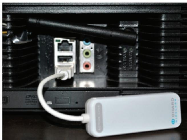
3. No corpo do transmissor sem fio, existe uma luz azul tênue que se acende de forma contínua quando a Lousa Digital está em modo de comunicação permanente com o Projetor Interativo, conforme mostra a figura abaixo. Se a luz indicadora estiver piscando, significa que a conexão com a Lousa Digital não foi estabelecida.
