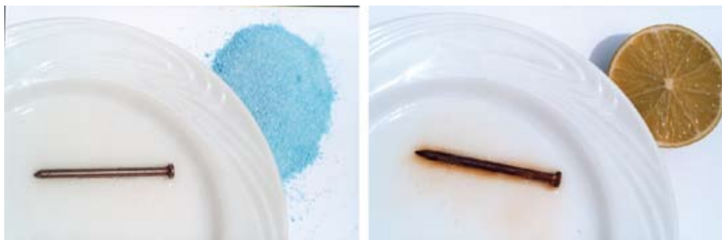
Figura 8a: prego com água e sabão
